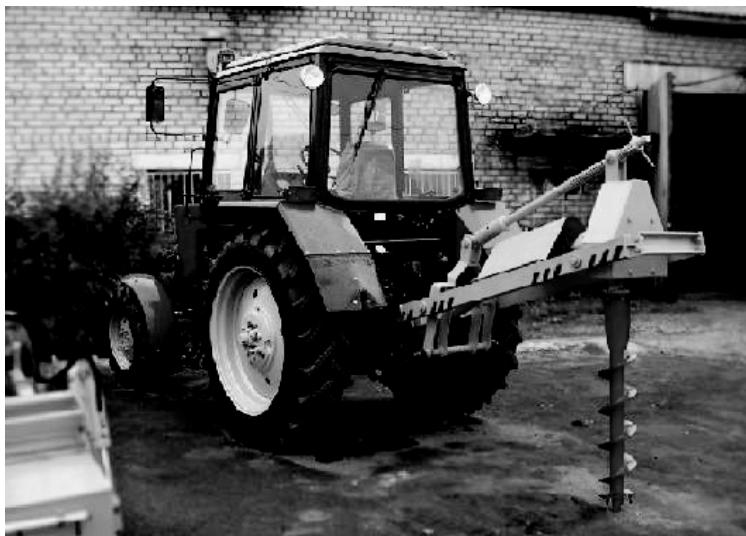
*Предназначен для бурения отверстий круглого сечения В грунтах до V категории на глубину до 1,3 метра.*
