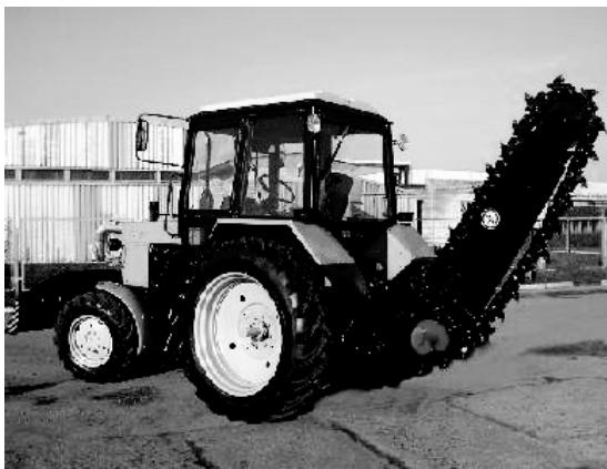
*Предназначен для прокладки газо- и водопроводов, сетей канализации, связи и электропередачи, используется на разных категориях грунта.*
