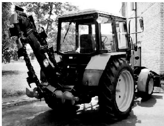
*Предназначен для прокладки газо- и водопроводов, сетей канализации, связи и электропередачи и позволяет производить быструю смену режущего органа для получения траншеи разной ширины, используется на разных категориях грунта.*
